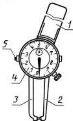
1 — ручка; 2 — неподвижный стержень; 3 — измерительный наконечник; 4 — отсчетное устройство; 5 — арретир
