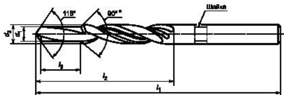
\* Допускается изготовление сверла с углом 120°.
